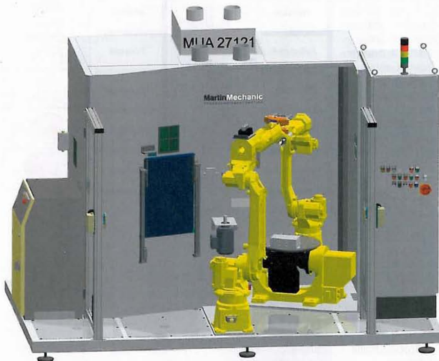
Drei Roboter kommen bei der Universal-Schweißzelle MUA 27121 zum Einsatz.
